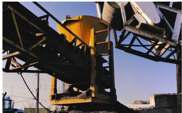
↑ Hintere Umlenktrommel eines Steinbruchförderbandes
