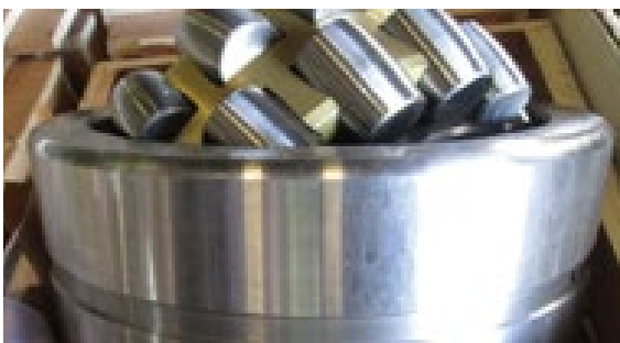
Handelt es sich hier um eine Fälschung? Ja. Zu erkennen an den fehlenden Transportbohrungen, der polierten Kantenrundung und den fehlenden Vertiefungen in den Wälzkörpern.
